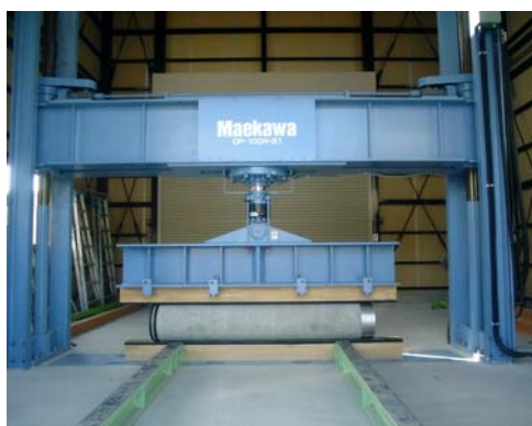
写真-2 外圧圧縮試験状況
